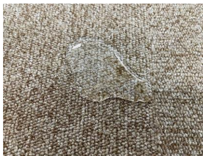
施工後初月 撥水
