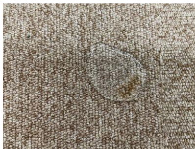
施工後3ヶ月 撥水
