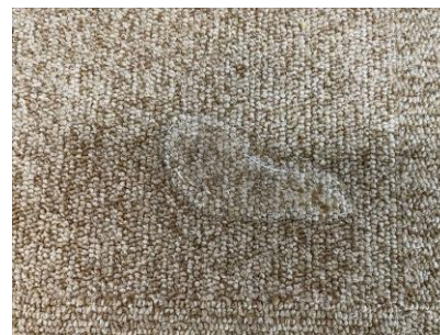
施工後11ヶ月 撥水
